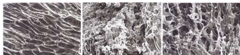
①外 (Chaff) 50μm ②木質物 (Wood ring) 20μm ③髄 (Pith) 50μm
